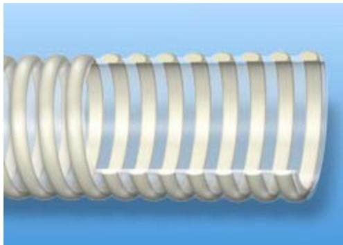
Шланг из пластичного ПВХ – пищевой, армированный внутри стенок ударопрочной спиралью из ПВХ. Внутренняя поверхность гладкая, внешняя волнистая. Устойчив к атмосферным и химическим воздействиям (перекачивает растворы серной кислоты – 25%, соляной – 10%, фосфорной – 85%, аммиак, калий хлористый и пр. – насыщенный раствор).
